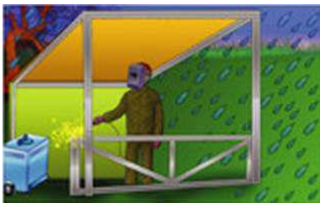
В дождь и снегопад необходимо работать под навесом
